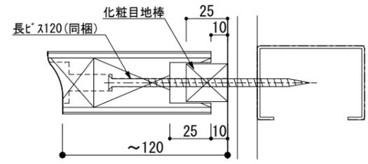
※壁際パネル幅が120mm以下の場合には脱落防止の為に長ビスで施工
