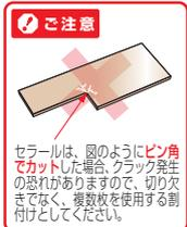
セラールは、図のようにピン角でカットした場合、クラック発生の恐れがありますので、切り欠きではなく、複数枚を使用する割付けしてください。
