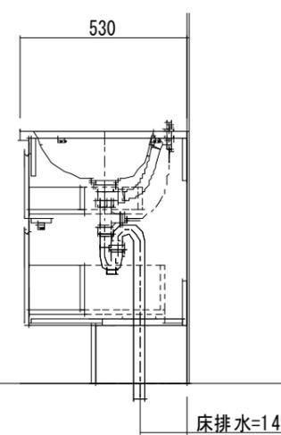
本仕様図の当社製品以外の箇所は参考図であり、部材固定部に十分な強度を持つ下地を設置のうえ、施工してください。
