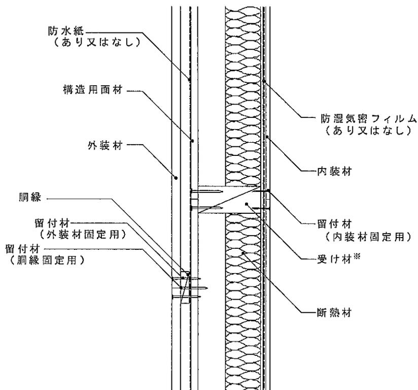
※受け材は、構造用面材及び内装材に横目地を設ける場合に使用する。
