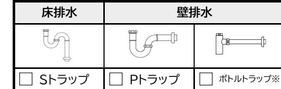
※★印の水栓は水受けパケットと干渉するためボトルトラップと併用不可です。
