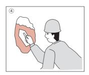
プライマーの粘着性のあるうちに APモルタルを金ゴテで下地にす り込むように施工します。更に金 ゴテにて平滑に仕上げます。施 工面に雨・雪・振動などを加え ないように硬化養生します。
