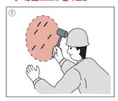
テストハンマー等で欠損部に軽い 打撃を与え欠損部周辺の脆弱部 を除去するとともにほこり、錆、 脆弱部などは除去し、清掃して 乾燥させてください。
