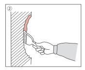
プライマーはJBX-125(断面修復 用防錆プライマー)をハケ等で塗 布してください。(塗布量約0.5~  $1 \text{kg/m}^2$
