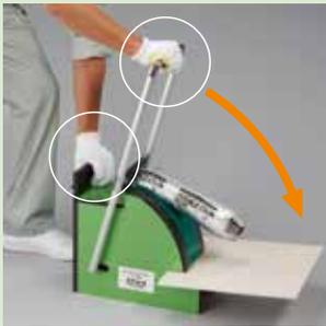
※ソーセージリンガーの底部に滑り止めを敷いておくとう作業がしやすくなります。
