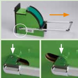
バーを引いて盛板方向に軸をずらす、この状態でバーを引き上げます。
