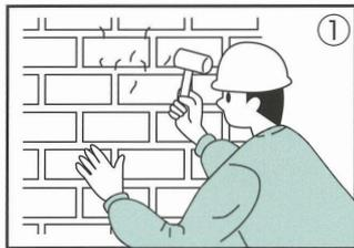
① テストハンマーを用いて、浮陸、空隙部の場所と範囲を確認します。
