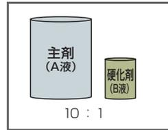
主剤及び硬化剤はよく攪拌した後、主剤：硬化剤=10：1（重量比）で秤量し、電動攪拌機で十分混合してください。
